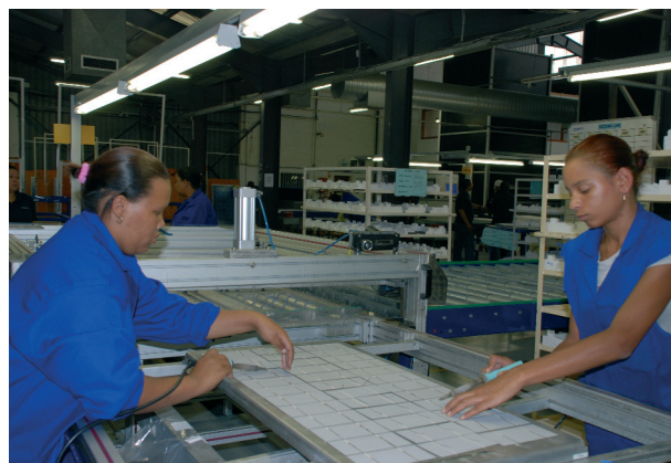
Atelier d'alignement des cellules photovoltaïques et de soudure Workshop for the aligning and welding of photovoltaic cells
